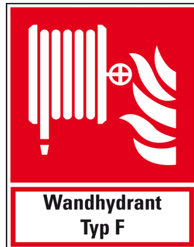
Abb. 5 Erkennungssymbol mit Hinweisschild Wandhydrant Typ F
